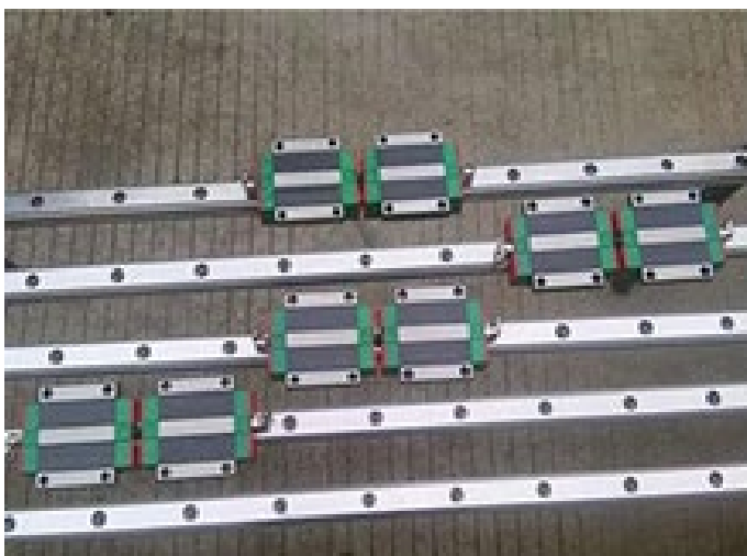
Усиленные направляющие и подшипники линейного перемещения
